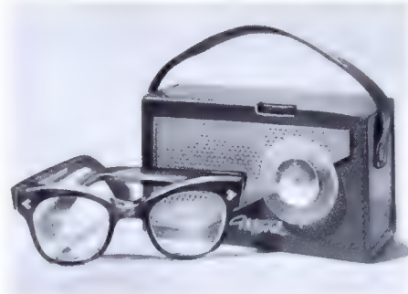
Bild 13. Der „Taschensuper“, das erste volltransistorisierte Gerät von Akkord-Radio, ist wirklich klein in den Abmessungen, wie der Vergleich zu einer Brille zeigt. Dabei gefällt er durch seine handliche standfeste Form und die echte Leder-tasche
